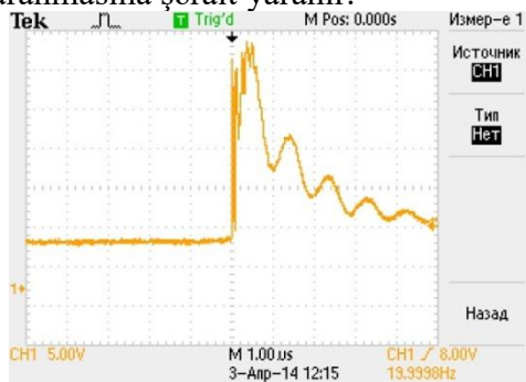
Şəkil 2. Mükəmməl kristallıq quruluşlu \text{Ag}_3\text{In}_5\text{Se}_9 monokristalında dalğa uzunluğu 535 nm lazer şüasının təsiri ilə yaranmış fotocərəyanın kinetikaşı
